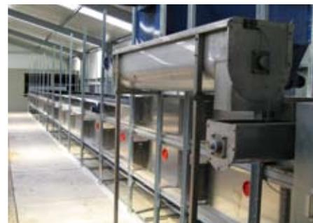
**Dorset Trocknungstechnik** wird beim Trocknen von Gärrest oder Schweinekot mit einem dreistufigen Luftwäscher kombiniert. Dieser wurde speziell für diesen Anwendungszweck entwickelt. Er wird komplett mit Steuerungs- und Pumpenraum in einem Container geliefert.
