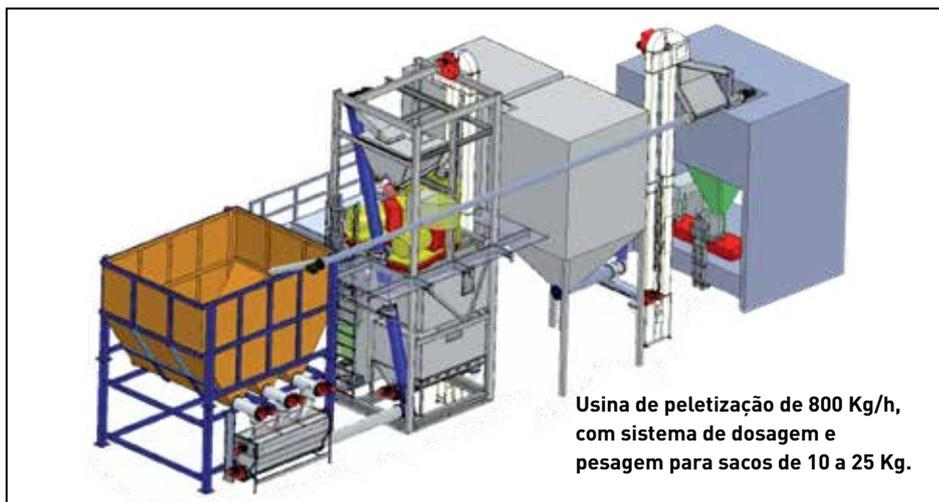
Usina de peletização de 800 Kg/h, com sistema de dosagem e pesagem para sacos de 10 a 25 Kg.
