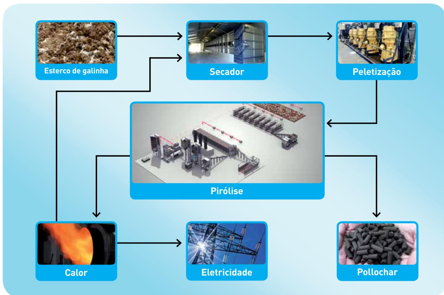
A pirólise é um processo eficiente para transformar grandes quantidades de esterco em energia elétrica e fertilizante concentrado. Não é um processo biológico, mas sim termoquímico, portanto, rápido, eficiente e contínuo.
