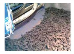
خشک کردن مواد فاضلاب برای خشک کردن مواد و محتویات فاضلاب، شرکت Dorset تاسیساتی کاملی را ارائه می نماید که می تواند فضولات را از چاله مخصوص دریافت و هوای خروجی را از مواد بیولوژیک عاری نماید. این سیستم ها به صورت متحرک/موبایل نیز قابل ارائه می باشد.
