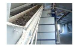
کود سالن از طریق نوار مخصوص به صفحات خشک کن منتقل میگردد. بنابراین کودخیس هم می تواند به راحتی انتقال یابد و نیازی به خشک کردن اولیه آن وجود ندارد که نتیجه آن کاهش هزینه برق مصرفی است.
