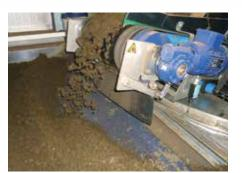
**خشک کردن مواد جامد از جدا ساز** مواد خشک بخصوص برای تولید سوخت و یا ایجاد بستر در گاوداریها مناسب است
