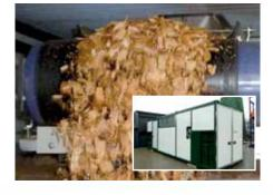
خشک کن ورقه های چوب سیستم خشک کن Tomo شرکت Dorset اختصاصا برای خشک کردن چوب طراحی شده است. خشک کردن چوب باعث افزایش ارزش آن به دلیل افزایش قابلیت اشتعال شده ضمن اینکه نیاز به هزینه کمتری برای انبار کردن آنها دارد.
